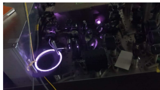
ファイバーラボ株式会社と協力して製 作した2 \mu mファイバ増幅器
