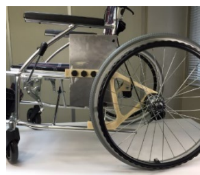
コンプライアントサスペンションの試用例 (左: 自動車用の小型モデル, 右: 車いす用の組み込み例)
